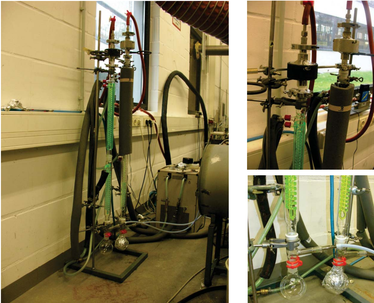
Abbildung 4-6: Aufbau zur parallelen Probenahme von PAK und Mutagenität aus dem Rohabgas. Links: Übersicht mit Kühlapparatur und Verbindung zum Abgassystem. Rechts oben: Filtereinheit, rechts unten: Kolben zum Auffangen des Kondensats. Zur Verdeutlichung wurde bei Probenahme A (links) die Isolierung und die Aluminiumfolie entfernt. Abdruck der Fotos mit freundlicher Genehmigung von Olaf Schröder (vTI)
