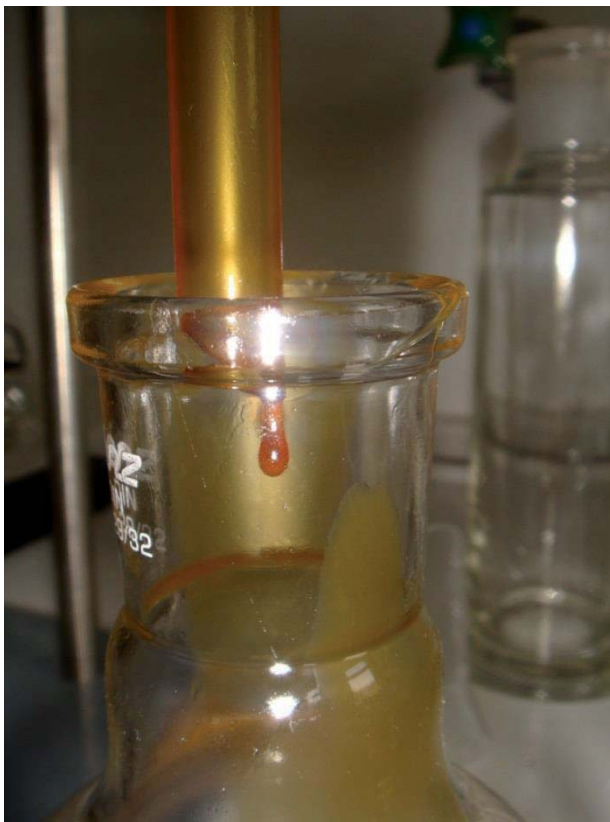
Abbildung 80: Dickflüssige, harzige Masse, gewonnen aus dem Kraftstofffilter nach Motorläufen mit GtLB15alt (Versuch XXV) im ESC-Test an Mercedes Benz OM 906 LA
