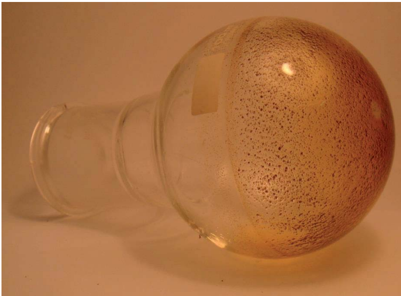
Abbildung 54: Rückstände eines B15-Blends mit gealtertem RME (nach 3.1.1 Methode der Alterung von Kraftstoffen) nach 250 °C (Versuch XVIII)
