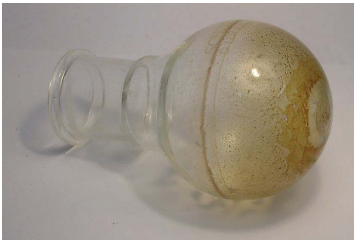
Abbildung 108: Rückstände nach Temperaturversuch mit n-Hexadecan (Versuch XXI)
