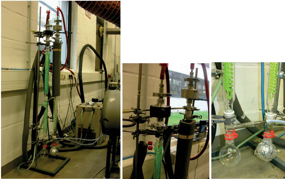
Abbildung 4: Paralleles Probenahmesystem zur Bestimmung der Mutagenität und für die PAK-Analytik.
