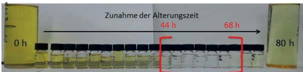
Abbildung 4: Optischer Alterungsverlauf von B10 + 6 % 1,3-Propandiol (Temperatur: 110 °C, Luftfluss: 200 mL/min, Dauer: 80 Stunden)
