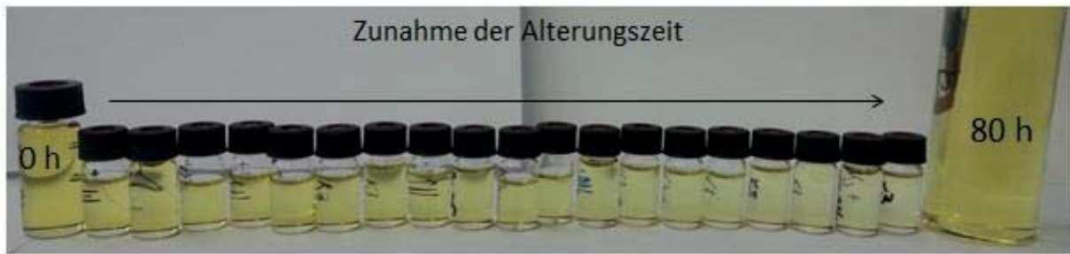
Abbildung 5: Optischer Alterungsverlauf von B10 + 4 % 1-Octanol (Temperatur: 110 °C, Luftfluss: 200 mL/min, Dauer: 80 Stunden)
