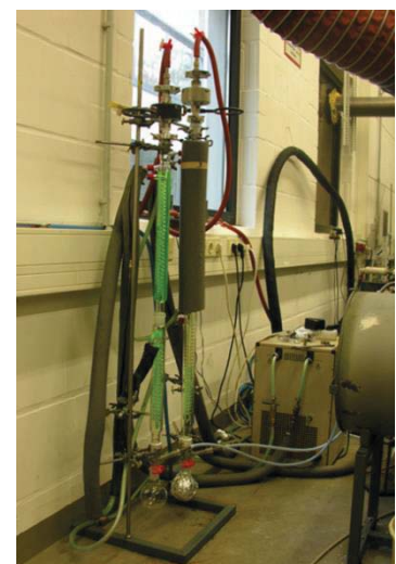
Abb. 1: Probenahmesystem für mutagene Abgasbestandteile
