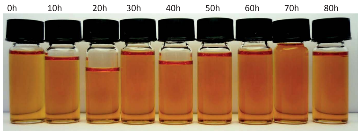
Abbildung 77: Optischer Alterungsverlauf von 67 % HEL + 7 % RME_{o,BHT} + 26 % HVO ( HEL_{o,BHT} ) von 0 bis 80 Stunden
