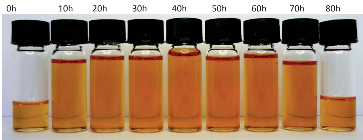
Abbildung 71: Optischer Alterungsverlauf von 66,95 % HEL + 7 % UCOME_{m.BHT} + 26 % HVO + 0,05 % R33 Performance Additive ( HELU_{m.BHT}ADD ) von 0 bis 80 Stunden
