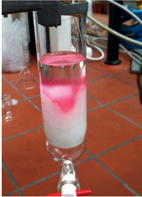
Abbildung 6-17: Verfärbung des Silikagels 60 nach Kontakt mit HVO
