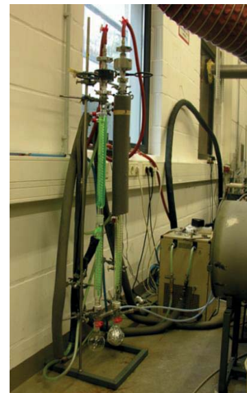
Abbildung 1 Probenahmesystem für mutagene Abgasbestandteile
