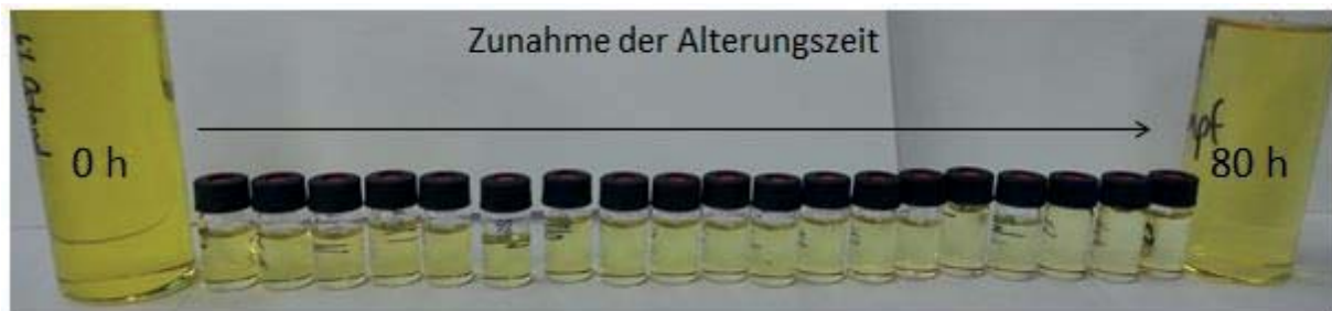
Abbildung 6: Optischer Alterungsverlauf von B10 + 6% 1-Octanol (Temperatur: 110 °C, Luftfluss: 200 mL/min, Dauer: 80 Stunden)
