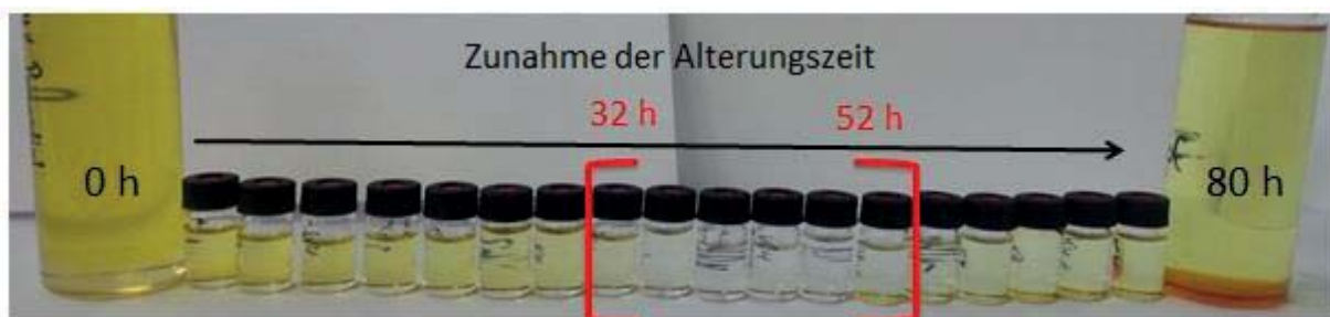
Abbildung 3: Optischer Alterungsverlauf von B10 + 4 % 1,3-Propandiol (Temperatur: 110 °C, Luftfluss: 200 mL/min, Dauer: 80 Stunden)
