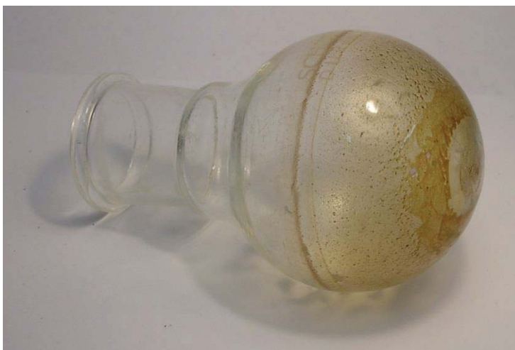
Abbildung 108: Rückstände nach Temperaturversuch mit n-Hexadecan (Versuch XXI)
