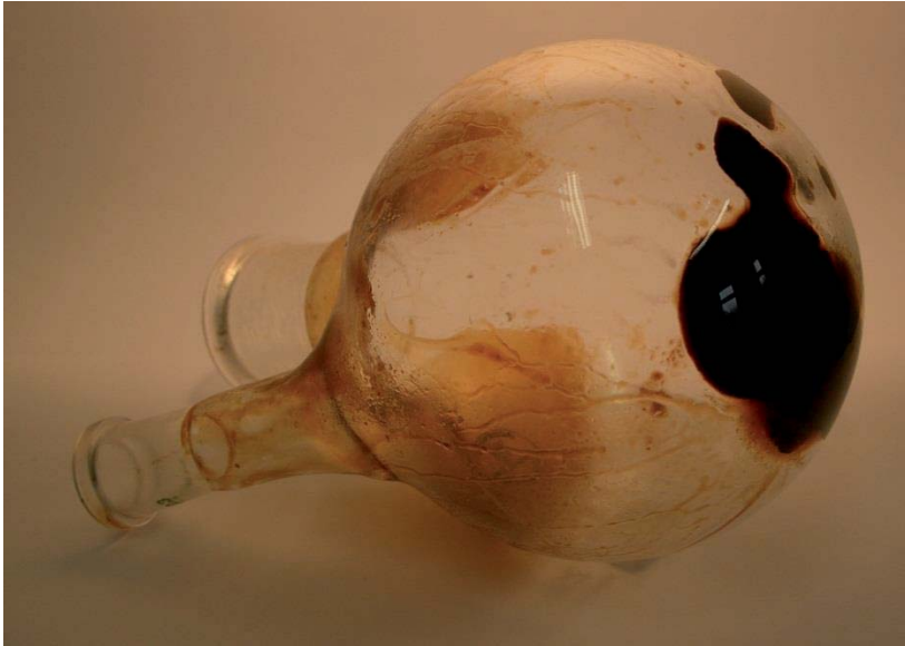
Abbildung 55: Kolbenrückstand nach Erhitzen der Sedimente eines B15-Blends mit gealtertem RME (nach 3.1.1 Methode der Alterung von Kraftstoffen) auf 250 °C (Versuch XX)
