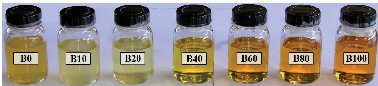
Abbildung 5: Sonnenlichtversuch; Blends mit Dieselkraftstoff und verschiedenen Anteilen von Biodiesel
