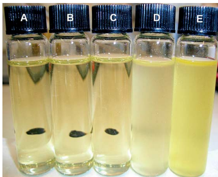
Abbildung 6-18: Untersuchung zur Eignung von ausgewählten 1-Alkoholen als Lösungsvermittler in RMEalt-20-Blends im Vergleich zu TBC und RME (5% Lösungsvermittler-Anteil)
