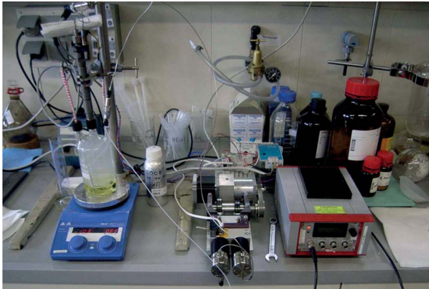
Abbildung 9-1: Einspritzprüfstand Variante 1 (Kreislauf aus Hochdruckpumpe, Einspritzdüse und Einspritzkammer)
