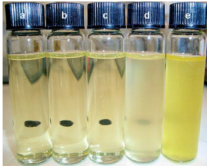
Abbildung 6-17: Untersuchung zur Eignung von ausgewählten 1-Alkoholen als Lösungsvermittler in RMEalt-20-Blends im Vergleich zu TBC und RME (10% Lösungsvermittler-Anteil)
