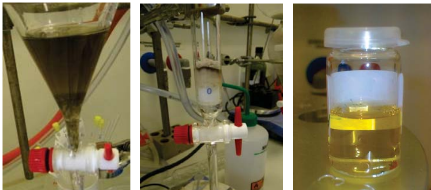
Abb. 3-10: Bildung eines dunklen Niederschlags an der Unterseite des Scheidetrichters (links); Katalysator-Rückstand auf Silicagel (mitte); Katalysator-freier Biodiesel (rechts)
