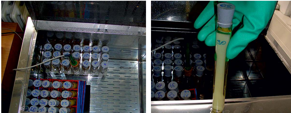
Abbildung 4.1-1: Untersuchungen zur Materialverträglichkeit (Kunststoff); temperierte Probenkammer (links); Beispiel einer Probe (Prüfkörper in Kraftstoff) (rechts)
