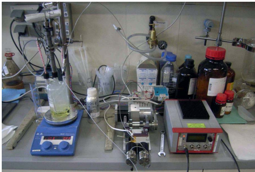
Abbildung 4.3-10: Einspritzprüfstand Variante 1 (Kreislauf aus Hochdruckpumpe, Einspritzdüse und Einspritzkammer) (ASG)
