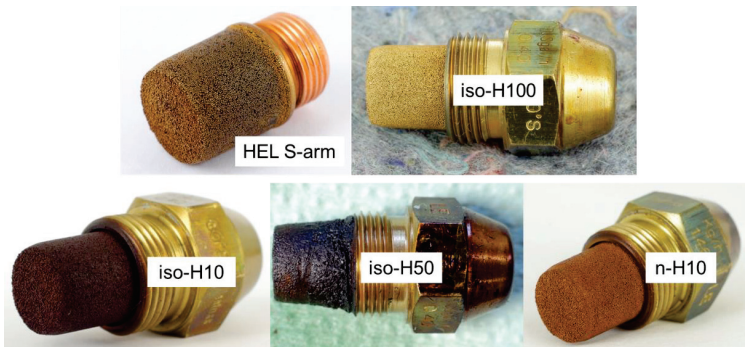
Abbildung 7: Düsensinterfilter nach den Verbrennungsversuchen mit verschiedenen Blends: iso-H100: isomerisiertes HVO; iso-H10: Mischung 10 % isomerisiertes HVO mit Heizöl EL schwefelarm; iso-H50: Mischung 50 % isomerisiertes HVO mit Heizöl EL schwefelarm; n-H10: Mischung aus 10 % teilisomerisiertem HVO und Heizöl EL schwefelarm [nach Feldho 16].
