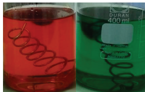
Abbildung 6: Mitteldestillat / OME Blend (50/50) vor (links) und nach (rechts) der thermischen Belastung nach DIN EN 51371
