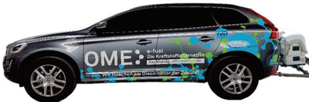
Abbildung 14: OME Versuchsfahrzeug mit PEMS-Aufbau
