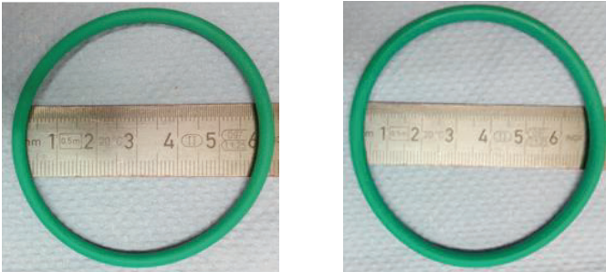
Abbildung 2: O-Ring (FKM mit PTFE-Überzug) vor (links) und nach (rechts) dem Versuch mit OME 5
