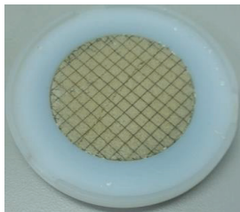
Abbildung 4: Cellulosenitrat-Filter während der Bestimmung der thermischen Stabilität von OME 3-5
