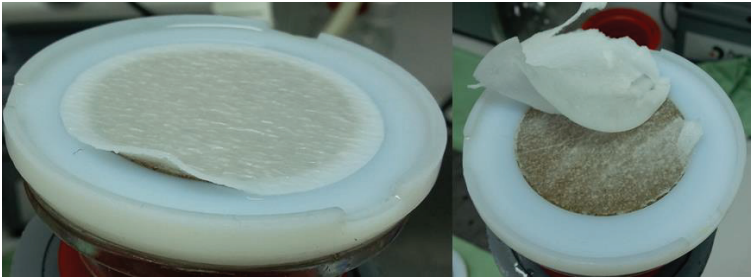
Abbildung 5: Glasfaser-Filter während der Bestimmung der thermischen Stabilität von OME 3-5
