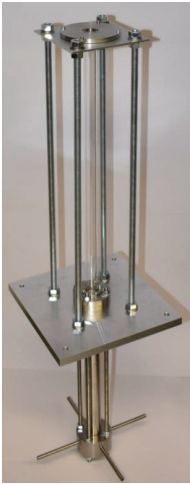
Bild 3: Hauptteil der Versuchsanlage für Mischungs- und Flammenstabilisierungsmessungen (links) und umfangreiche Ergebnisse zum Flammenrückschlags-Limit für Ammoniak-Wasserstoff-Gemische bei verschiedener Brennstoff-Luft-Mischung (rechts) [14].
