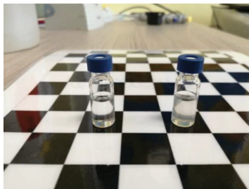
Abbildung 3: Der gleiche Dieselkraftstoff vor der Zugabe und nach der Zugabe von 3 Vol-% Solketal. Links: DK mit 3 Vol-% Solketal. Rechts: Trüber DK.
